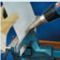
Façonner des plaques
