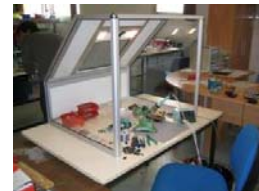
Campana extractora cabina
